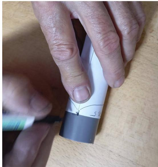
Tracer deux points à 20 mm du bord du tube avec une feuille de papier enroulée autour du tube et marquée. Un marquage précis est important pour un montage correct.
