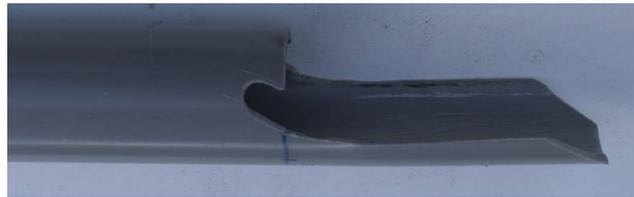
Les deux encoches faites à la lime permettront de placer l'élastique (voir montage ci-dessous). La longueur et la hauteur dépendent de la selle et de sa fixation au vélo .
