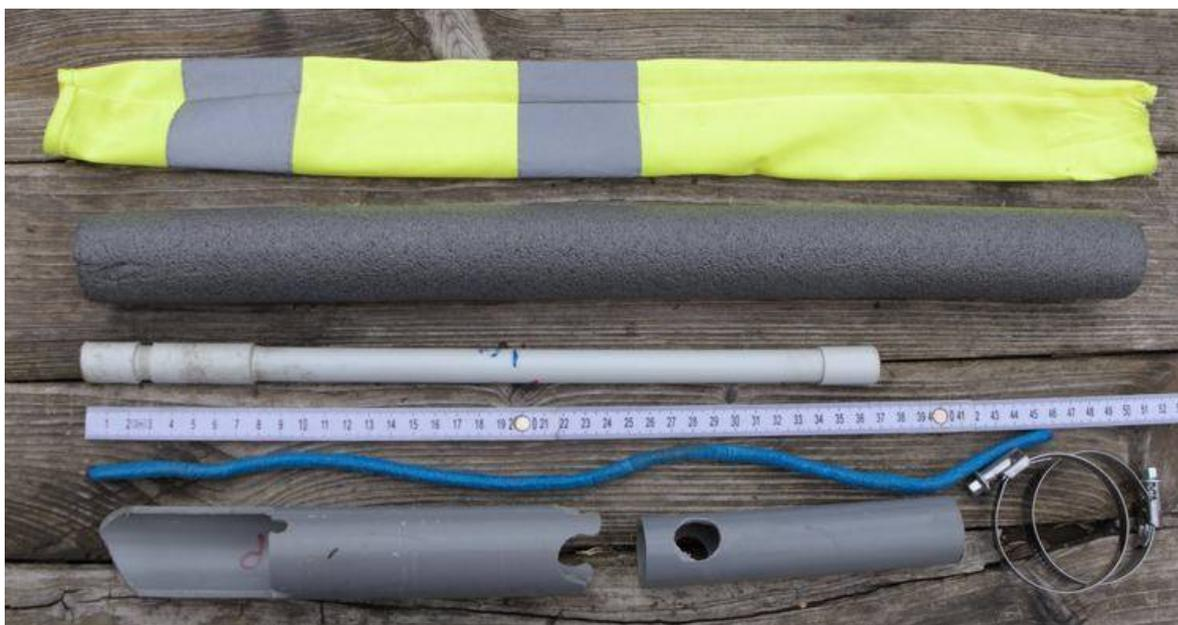
tube de décharge renforcé de 40 mm de diamètre : 30 cm
