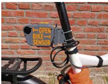
Le boîtier mesure la distance latérale des véhicules qui dépassent.
